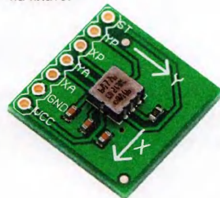
Акселерометр на плате.
